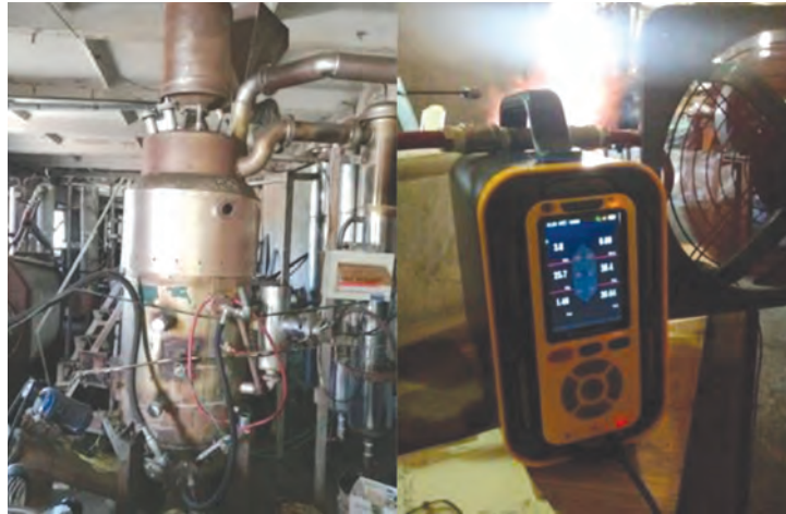
Рисунок 3. Робота газифікатора та газоаналізатора в режимі онлайн вимірів у процесі газифікації [4]
